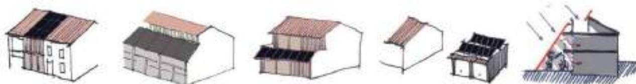
*Exemples d'intégration des panneaux sur un bâtiment d'habitation neuf : en verrière ou en serre, faisant office de garde-corps ou de pare-soleil ... Le panneau doit être considéré comme un élément de projet.*
