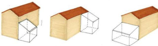
Exemples de toitures à un pan pour une construction accolée à un volume principal
